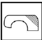
Limpar adequadamente a superfície a ser pintada, removendo partes soltas, ferrugem, oleosidades e resíduos impregnantes, com Solução Desoleante 400.
